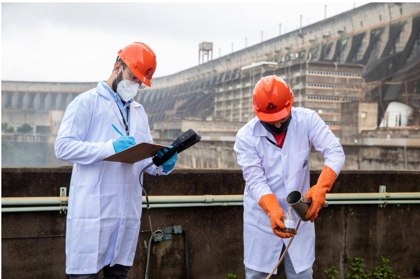
*Técnicos do Núcleo de Inteligência Territorial (NIT.IB) integram a equipe de coleta de amostras em diferentes pontos do município, incluindo as Estações de Tratamento de Esgoto da Itaipu.*
